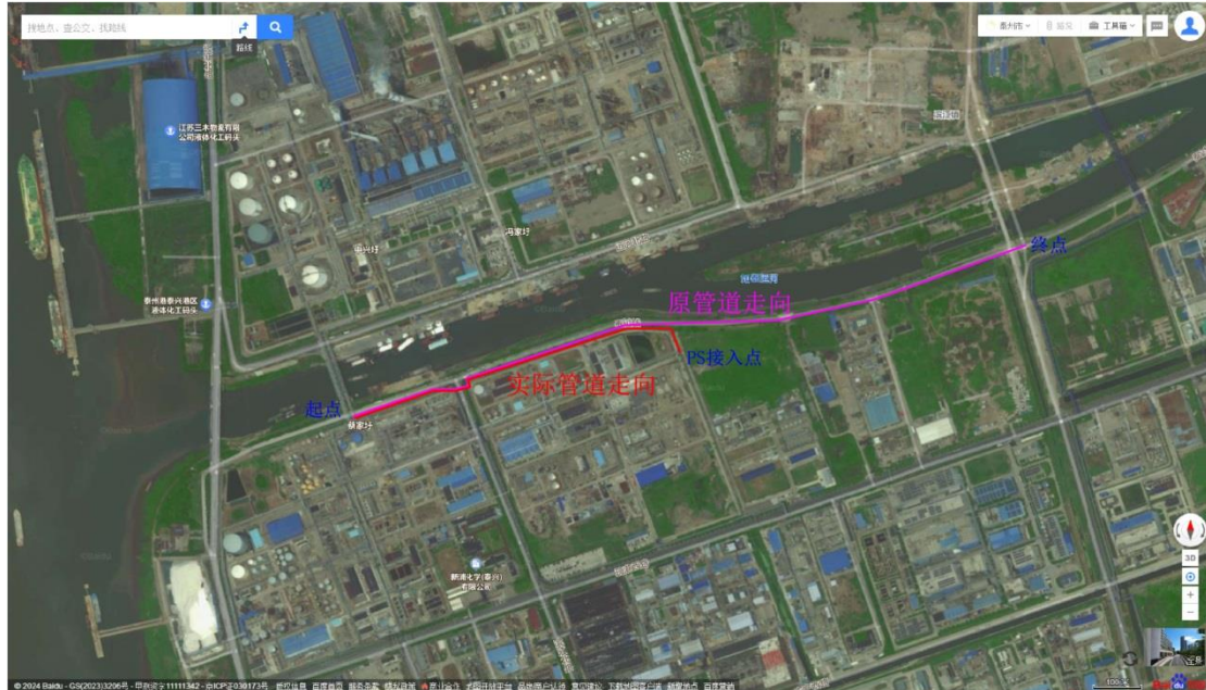
工业水管道路径变换情况说明图
