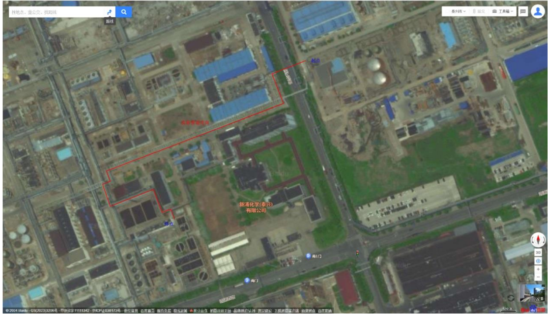
生产废水管道路径说明图
